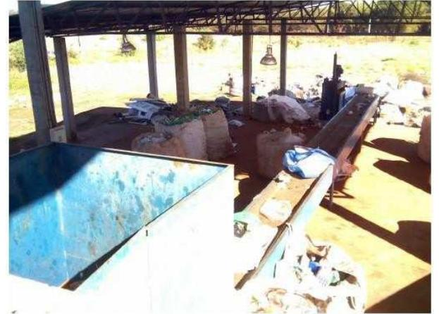
**Figura 46 – “Esteira” unidade de processamento de lixo**
